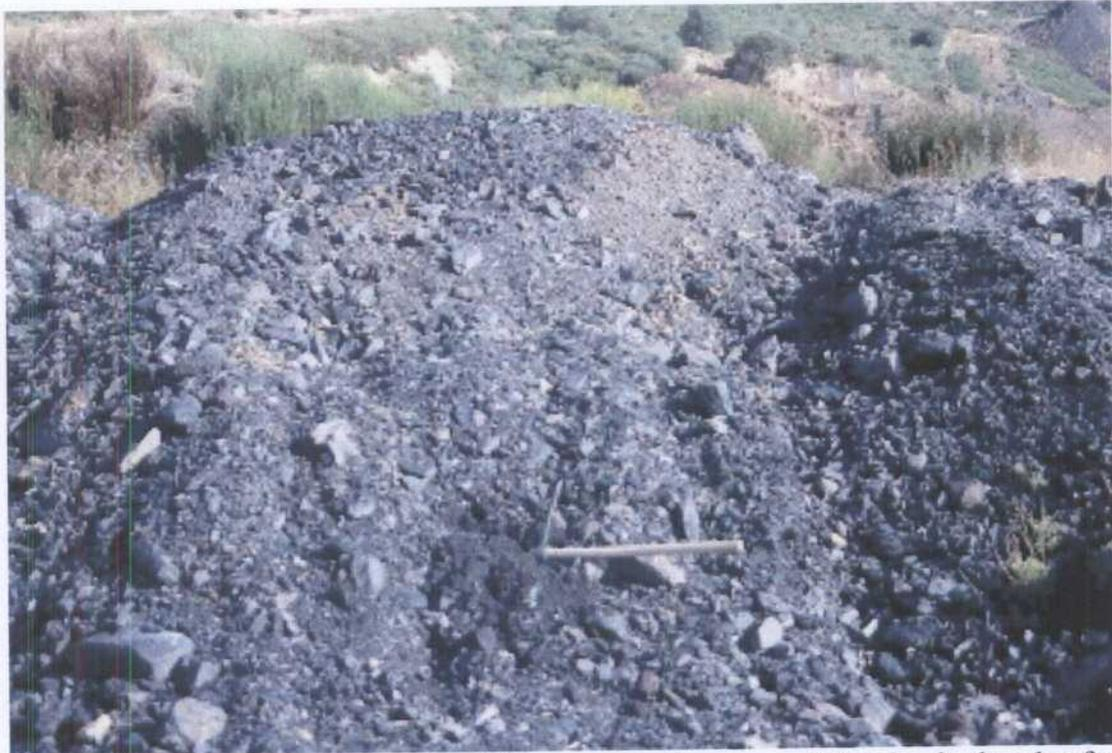
**Fotografía A.III.9.** Acopios de estériles muy carbonosos al borde de la plataforma superior de una escombrera en la Zona de Miranda-Minas de la Mora (septiembre, 2001).
