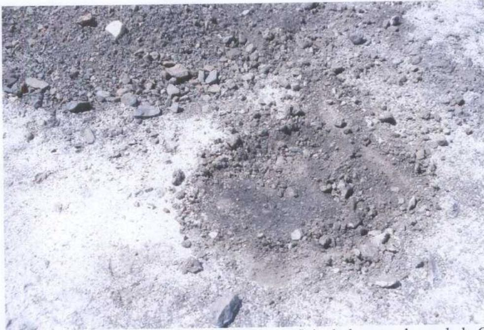
**Fotografía A.III.15.** Precipitados salinos en la superficie de la escombrera de la Corta de las Ranas (abril, 2002).
