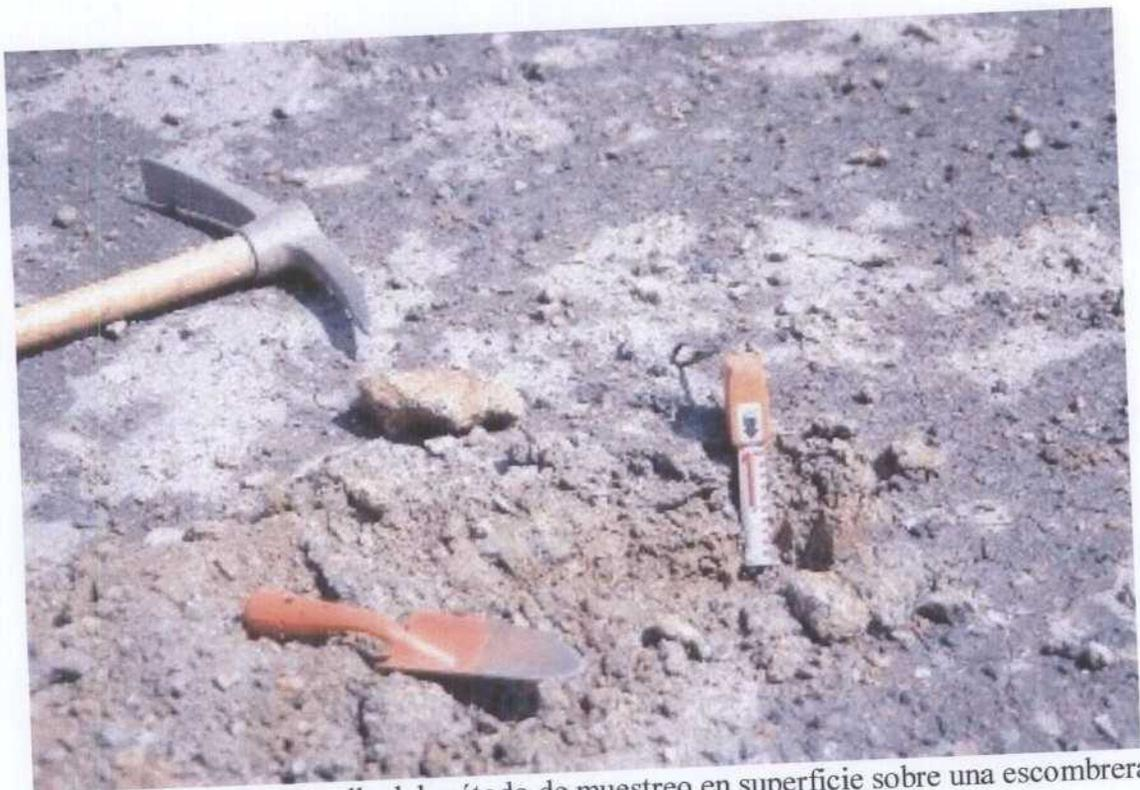
**Fotografía A.III.30.** Detalle del método de muestreo en superficie sobre una escombrera.
